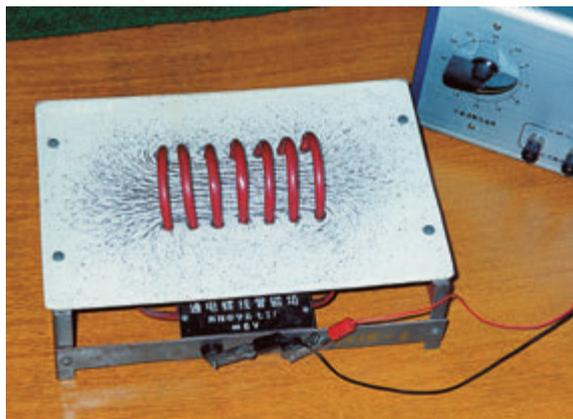
图5.2.5 通电螺线管周围的铁粉排列
