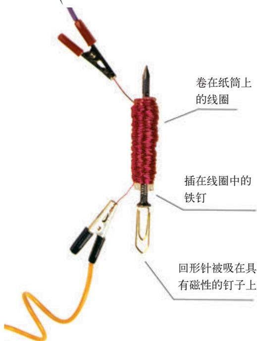
图5.2.7 研究通电线圈的磁性强弱
