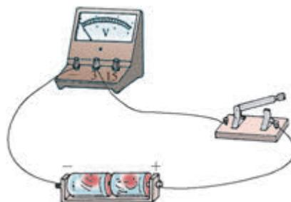
图 4.3.14 用电压表测电源电压
