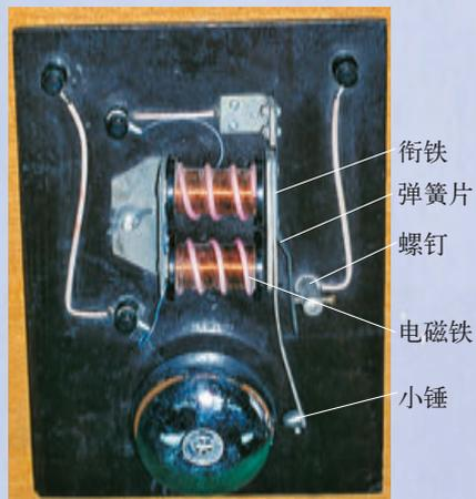
图5.2.9 电铃结构图
