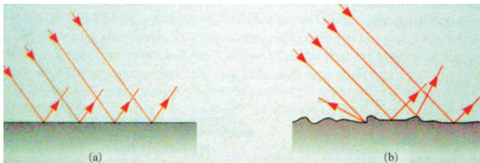
图2.1.9 镜面反射与漫反射的分析图
