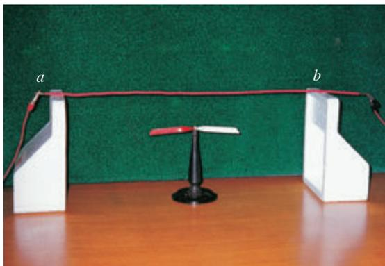
图5.2.1 电流的磁效应实验
