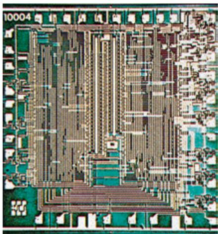
图 4.4.7 放大镜下的集成电路
