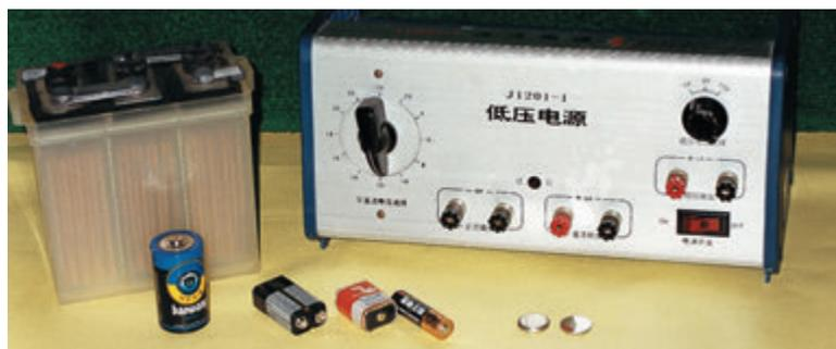
图 4.3.8 实验室常用的直流电源
