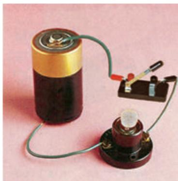
图 4.3.1 电池、小灯泡、开关实验电路
