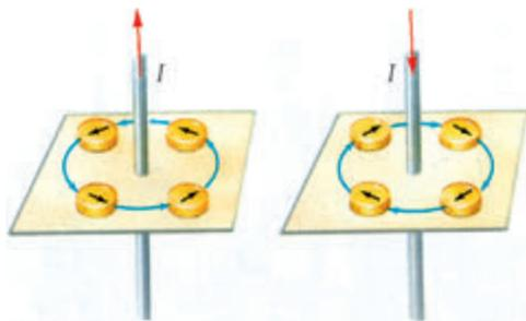
图5.2.3 直线电流磁场中的磁感线
