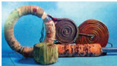
图5.3.5 法拉第的实验装置
