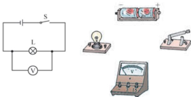
图 4.3.15 电压表的连接
