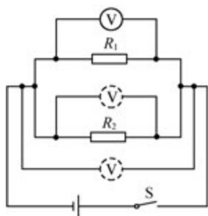
2. 把电压表先后分别并联在电阻 $R_1$ 和 $R_2$ 的两端,再把电压表连接在 $R_1$ 与 $R_2$ 并联电路的两端(如图4.5.7所示)分别测出它们的电压,将你得出的结论记录下来。
