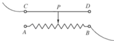
图4.4.8 滑动变阻器的结构示意图
