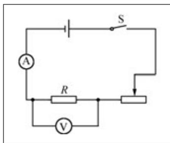
图4.5.1 研究电流规律的实验电路图
