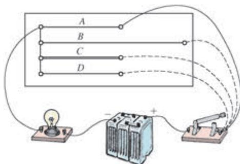
图4.4.2 研究导体电阻大小的实验装置
