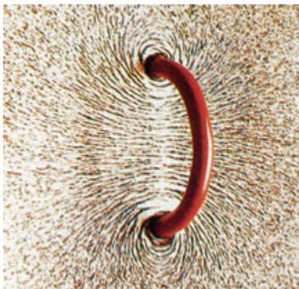
图5.2.4 环形电流周围的铁粉排列
