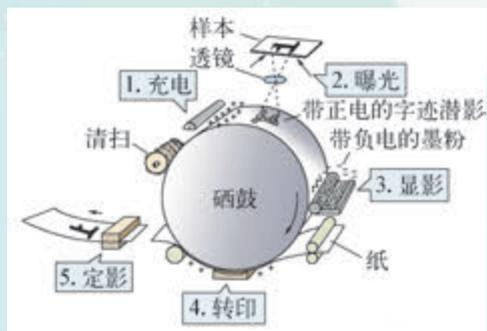
图4.1.7 复印机结构示意图
