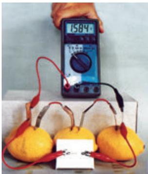
图4.3.10所示的是由三个柠檬组成的电池组。每个柠檬上插入一片铜片和一片锌片组成一个电池，仔细观察可以发现：这三个柠檬电池的连接方式是怎样的？这个电池组能提供的电压由数字电压表直接显示为多少伏？
