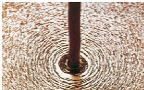
图5.2.2 直线电流周围的铁粉排列
