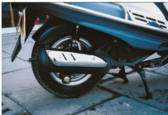
图 1.3.2 摩托车消声器
