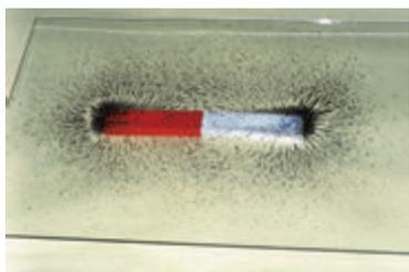
图5.1.6 条形磁铁周围的铁粉排列
