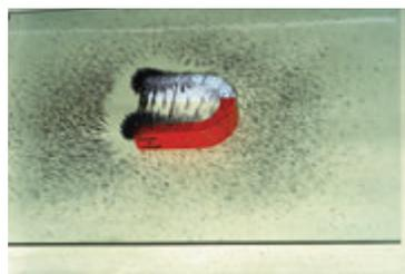
图5.1.7 蹄形磁铁周围的铁粉排列
