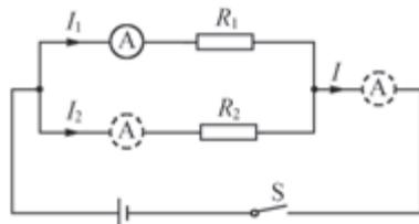
图4.5.6 并联电路的电流
