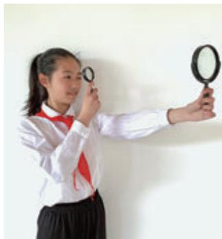
图2.3.7 用两个不同焦距的透镜看物
