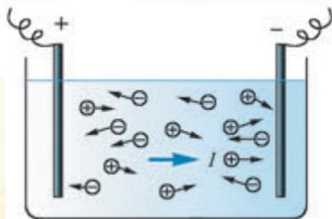
图4.3.2 溶液导电示意图
