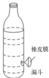
图2.2.2 研究液体对侧壁的压强
