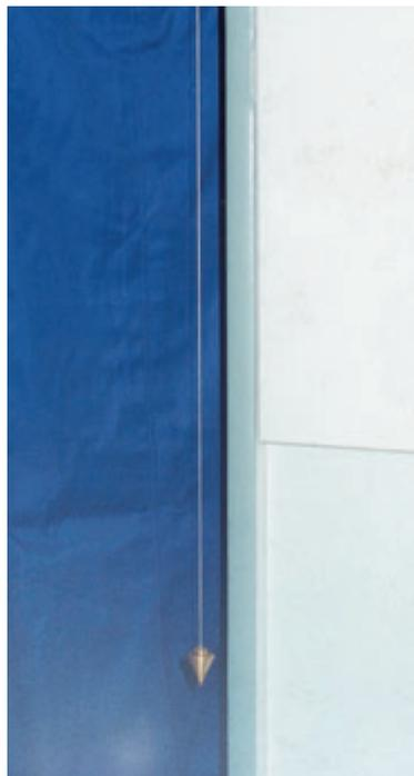
图 1.3.4 用重垂线检验橱柜壁是否在竖直方向
