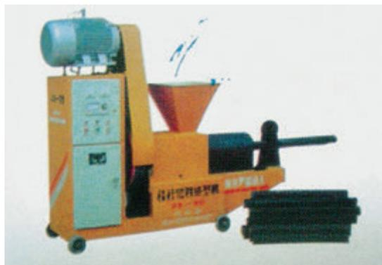
图6.4.4 秸秆燃料压缩成型机
