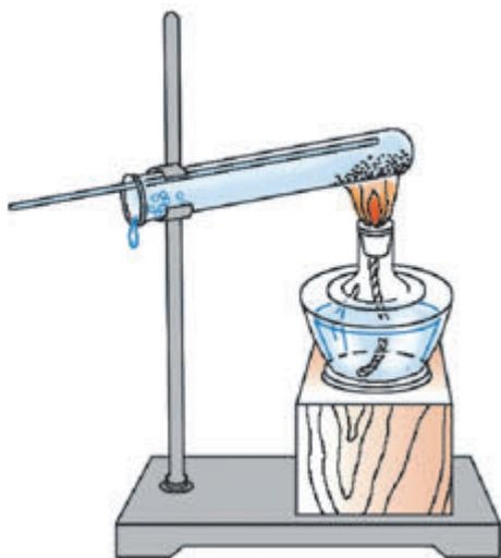
图3.1.3 用氢气还原氧化铜的实验装置
