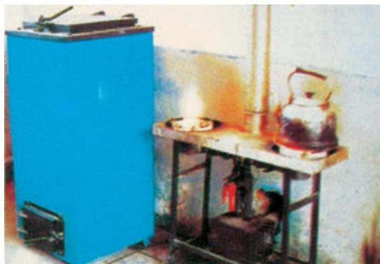
图6.4.5 家用生物质能气化炉灶
