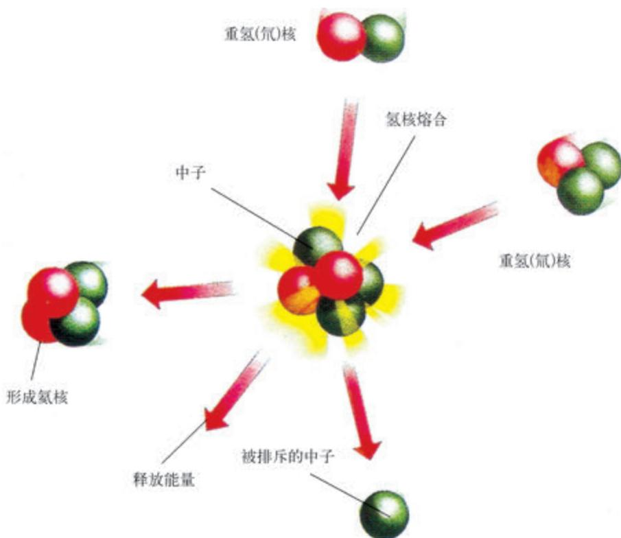
图6.3.4 氢核的聚变反应
