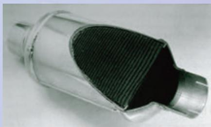
图3.3.8 汽车尾气催化转化器
