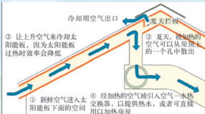
图6.2.4 太阳能房屋原理示意图
