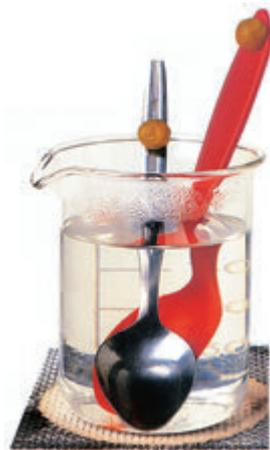
图3.1.7 金属的导热性
