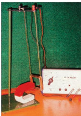
图6.1.4 通电导体在磁场中受到安培力作用
