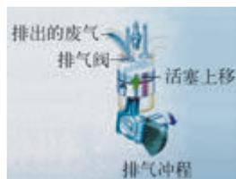
图7.3.2 汽油机的工作过程
