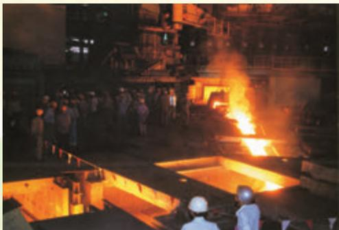
图3.2.9 宝钢一期工程铁水出炉
