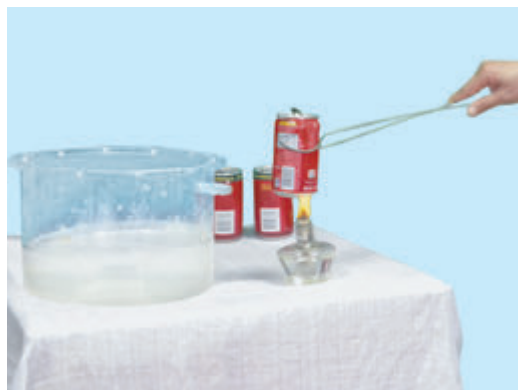
图2.1.3 压扁易拉罐实验
