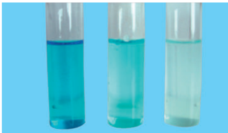
图 1.4.1 三种不同浓度的硫酸铜溶液
